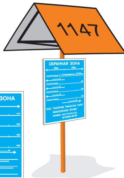
Знак «Закрепление трассы газопровода на местности»
